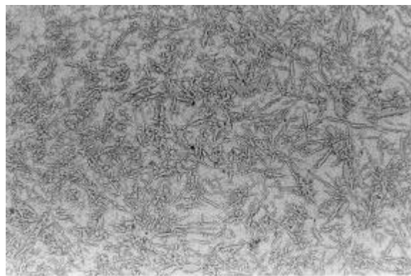
Figura 7. Estrutura dendrítica do arame de 1mm.(400x)
