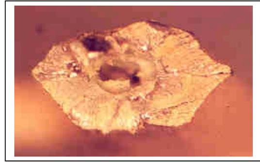
Figura 6. Vazios em um contorno lateral da grade. 20x. 400 μm
