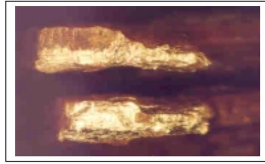
Figura 4b. Seção trans.da grade de ligação pequena (sup.) e unida (inf.).10x. 800 μm
