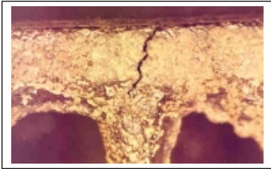
Figura 4a. Trinca no contorno superior da grade de Pb-Ca-Sn-Ag. 20x. 400 μm
