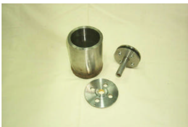
(a) Câmara de pressão usada no ensaio hidrostático
