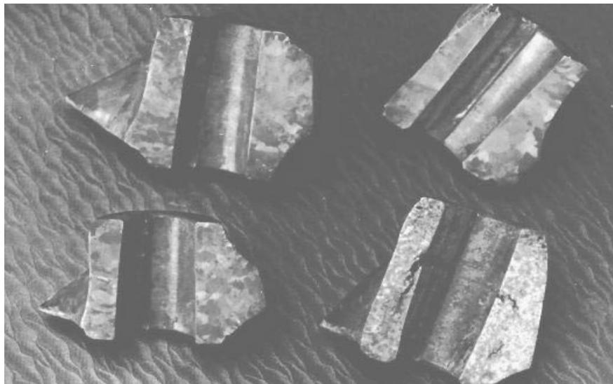
Figura 2. Seções longitudinais de diferentes cubos de propulsores analisados com predominância de estruturas colunares e equiaxiais grosseiras.
