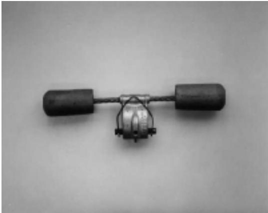
Figura 3 - As figuras acima são o neutralizador utilizado como PED (figura à esquerda) e sua respectiva função resposta em frequência obtida experimentalmente (figura à direita).
