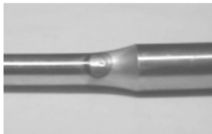
Figura 3 - Corpo de prova com micro-ponto de solda no raio de variação da seção.
