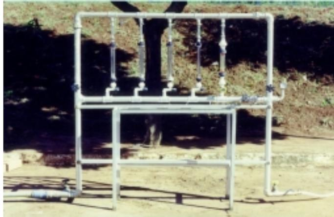
**Figura 4** – Sistema de Controle das variáveis de escoamento.
