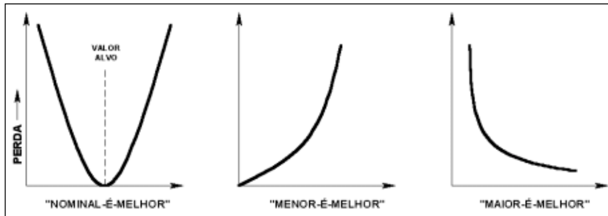
Figura 2. Representação gráfica da função Perda de Taguchi para diferentes especificações
