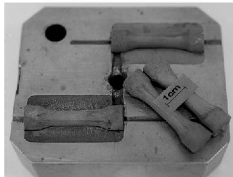
b) Molde de corpo de prova
