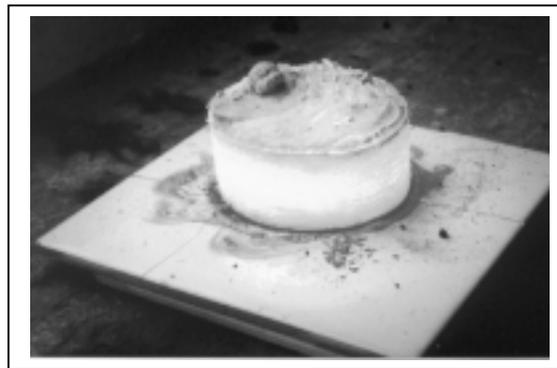
FIGURA 3: Amostra, imediatamente, após a reação de combustão.
