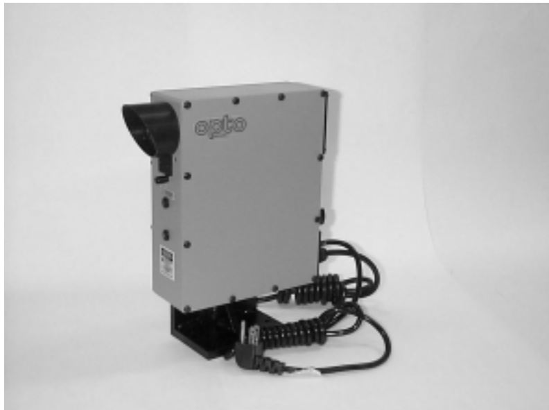
Figura 4 - Vista do medidor de distância por comparação de fase.
