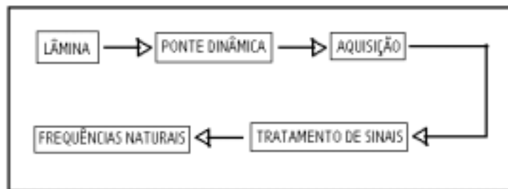
Figura 3 – Diagrama de bloco para obtenção das frequências naturais
