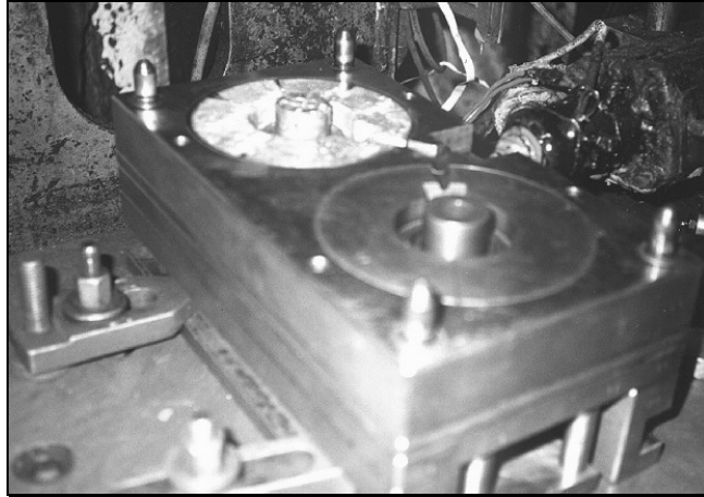
Figura 8. Molde com insertos de estereolitografia para injeção de cera
