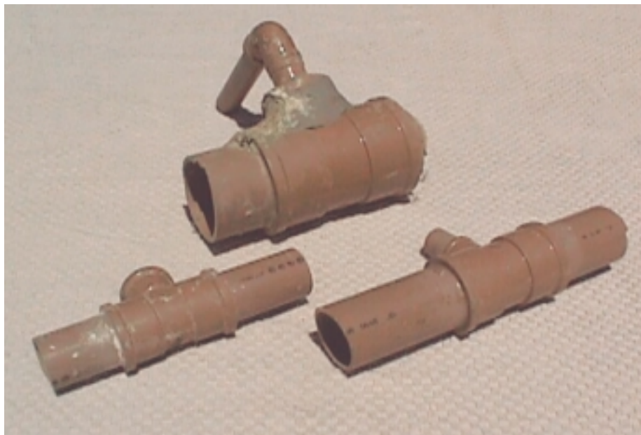
Figura 3. Conexões com falhas estruturais
