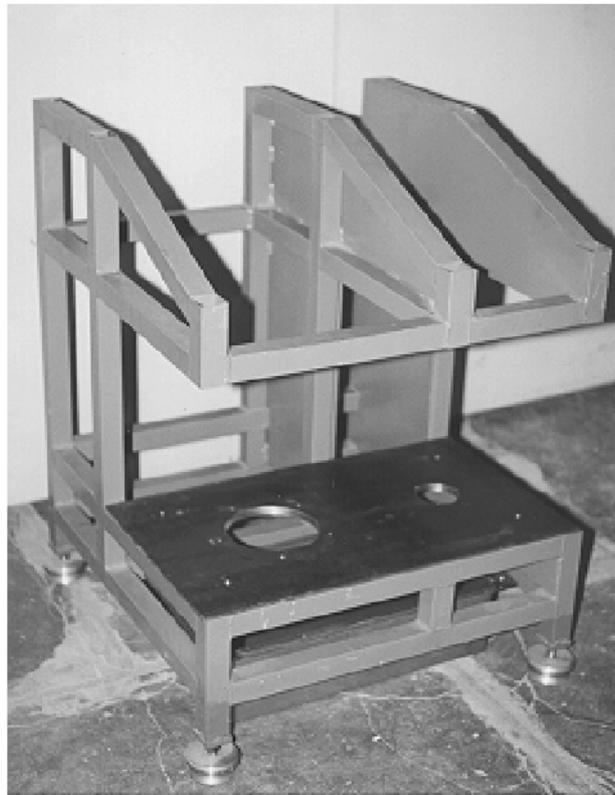
Figura 5 - Estrutura da injetora
