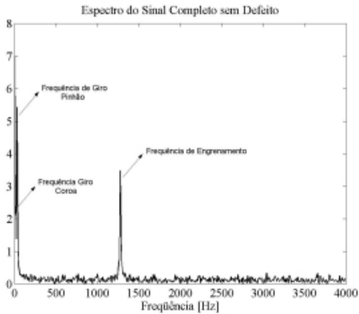
Figura 2. Espectro do sinal temporal simulado do par engrenado sem defeitos
