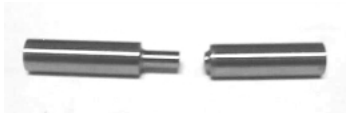
Figura 5. Corpo de prova de SAE 1020 com falha na extremidade da seção menor.
