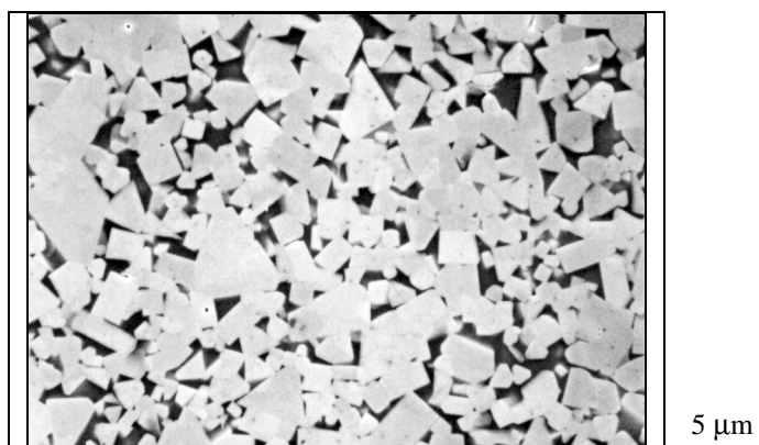
Figura 1 - Imagem original da microestrutura do metal-duro WC – Co.
