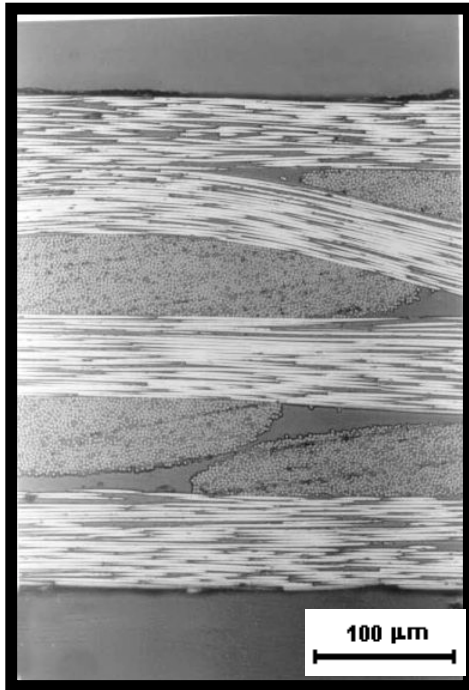
Fig. 2. - Seção transversal do interior do laminado [90/(0,90)]_s .
