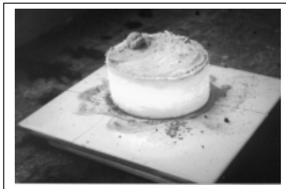
FIGURA 3: Amostra, imediatamente, após a reação de combustão.
