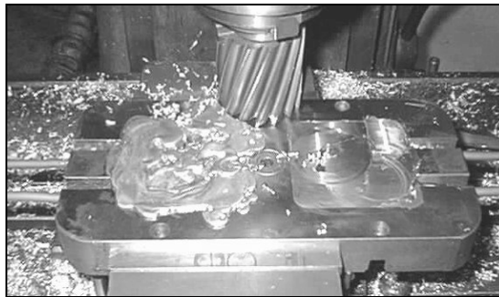
Figura 5. Usinagem da parte traseira
