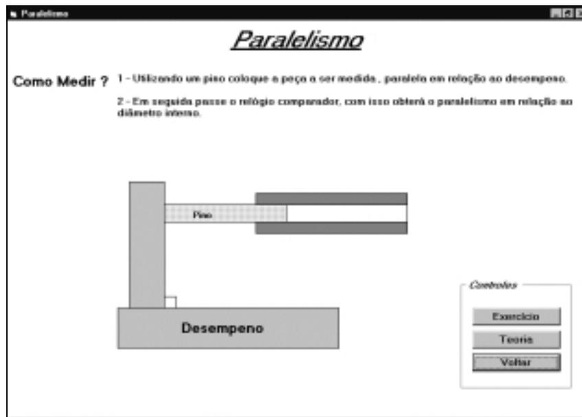
Figura 8 - Encaixando a peça no pino
