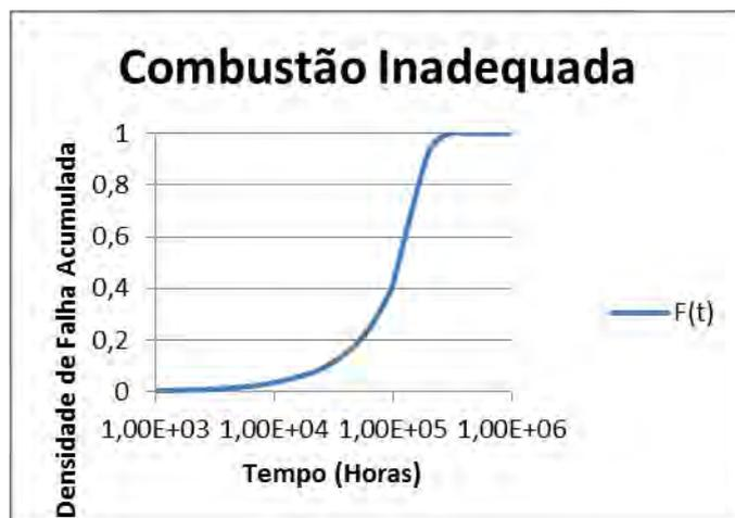
Figura 7. – Estimativa de falhas x Tempo do Kit Diesel Gás para Combustão Inadequada<sup>[4]</sup>
