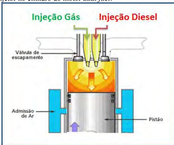
Fig. 1. Arranjo de injeção piloto e injeção de gás na câmara de combustão<sup>[4]</sup>.
