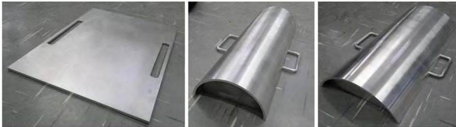
Figure 1. Manufacturing Mold ( $k=0\text{ m}^{-1}$ ,  $k=0.01\text{ m}^{-1}$ ,  $k=0.005\text{ m}^{-1}$ )
