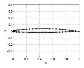
Figure 6. NACA 66206(Abbot et al, 1959).
