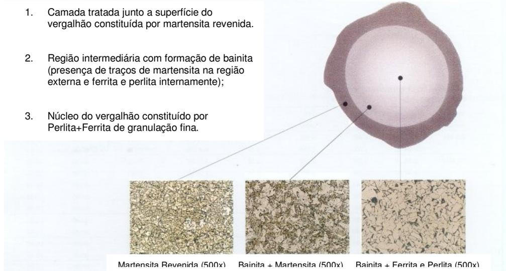
Figura 2. Corte em seção transversal de vergalhão com tratamento térmico superficial. Visualização das regiões afetadas através da transferência de calor.
