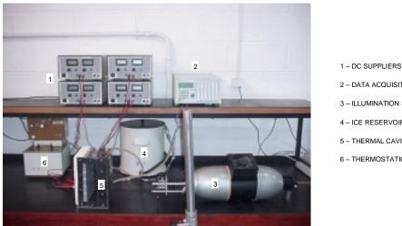
2 - DATA ACQUISITION SYSTEM 3 - ILLUMINATION SYSTEM 4 - ICE RESERVOIR
