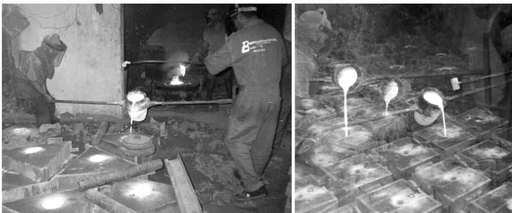
Figura 5 – Operação de vazamento do metal líquido nos moldes e ilustração da variação que normalmente ocorre na altura de vazamento.
