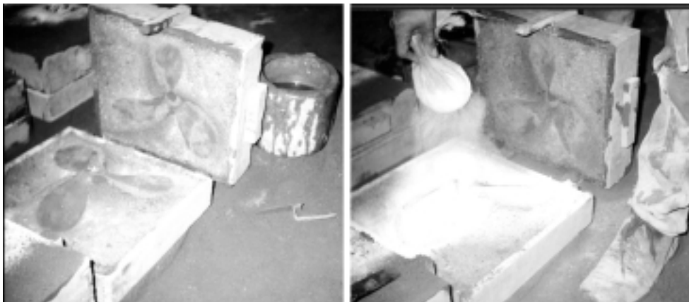
Figura 2 – Etapas da moldagem em que se vê claramente a raspa de madeira na interface de separação e o processo de adição da camada de carbureto às superfícies do molde.
