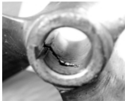
Figura 4 – Vazio localizado no interior do cubo.
