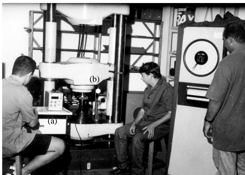
Figura 1. Fotografia do experimento de extrusão mostrando a prensa de laboratório (Heckert) de 980,7 kN (100 tf) de capacidade, o medidor de aquisição de sinais TMDE (a) e a localização do relógio comparador (b). O fundo de escala usado na prensa Heckert foi de 392,
