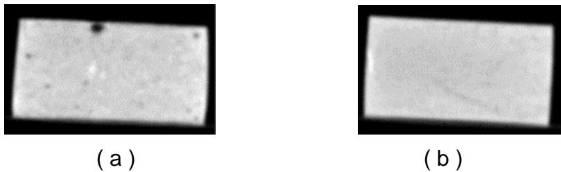
FIGURA 1 - Amostras de tomografia computadorizada: a) Sem controle inicial da temperatura da emulsão; b) Com controle inicial da temperatura da emulsão.
