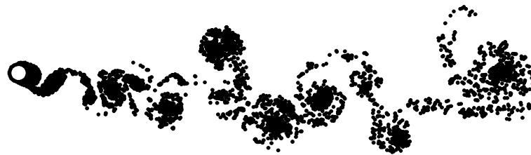
Figura 2. Cilindro circular: posição da esteira para t=300(0,1025) .
