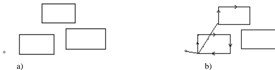
Figura 3: a) Moldes a serem cortados e b) trajetórias de corte dos moldes
