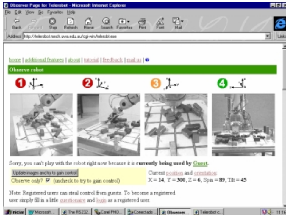
Figura 1 - TeleRobot: robô ASEA IRB controlado via Internet.
