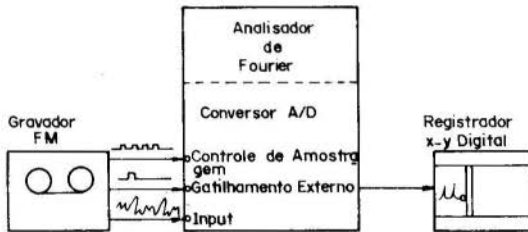
Figura 3: Instrumentação para análise no laboratório.
