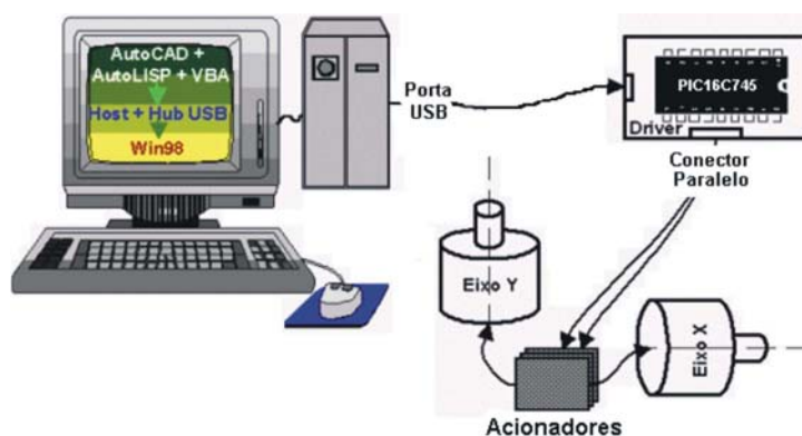
Figura 3. Interface CAD e dispositivos (motores de passo).
