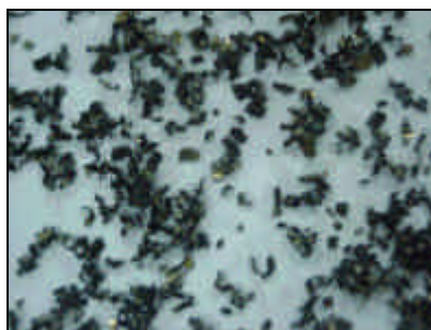
Figura 6. Cavacos obtidos durante ensaios do ferro fundido cinzento.
