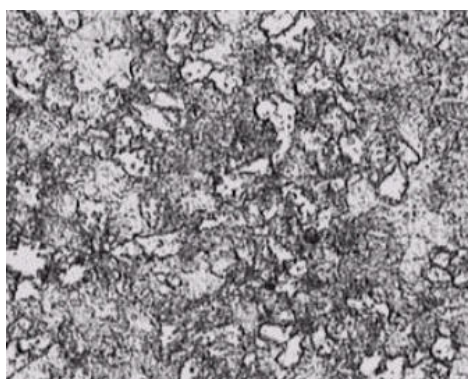
Figura 1 – Microestrutura do aço SAE 4140 como recebido. Ataque: nital 2%. Aumento: 900X.
