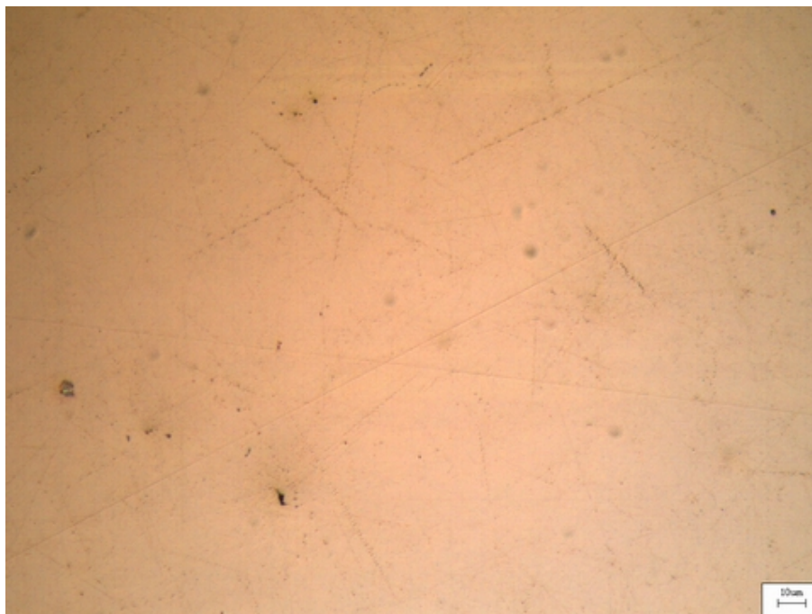
Figura 2. Imagem de aço BH adquirida em 500x
