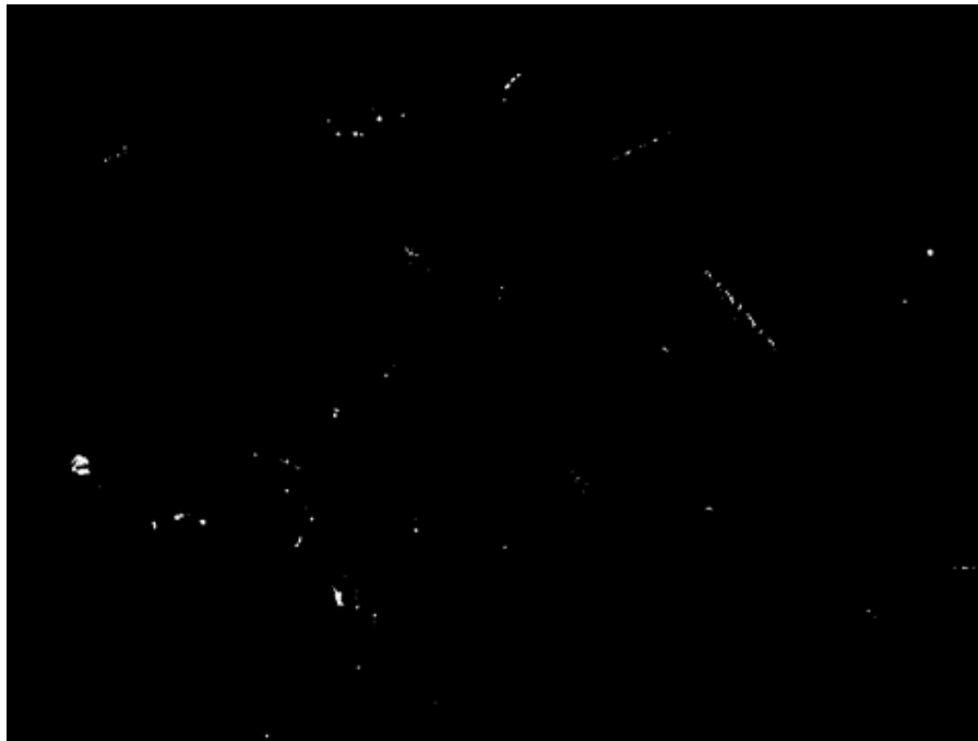
Figura 3. Imagem de aço BH binarizada através do limiar de Bernsen
