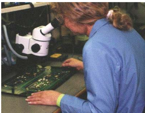
(a) Inspeção visual manual de placas de circuito impresso (ausência de componentes, qualidade da solda, etc.)
