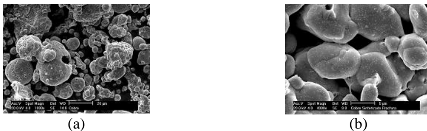
Figura 1 – Fotomicrografia do pó de cobre utilizado. a) Pó de cobre solto (ampliação 1000x) e b) sinterizado de cobre (ampliação 4000x).
