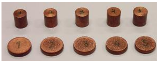
Figura 2 – Corpos de prova de cobre de densidades iniciais decrescentes antes e após deformação.
