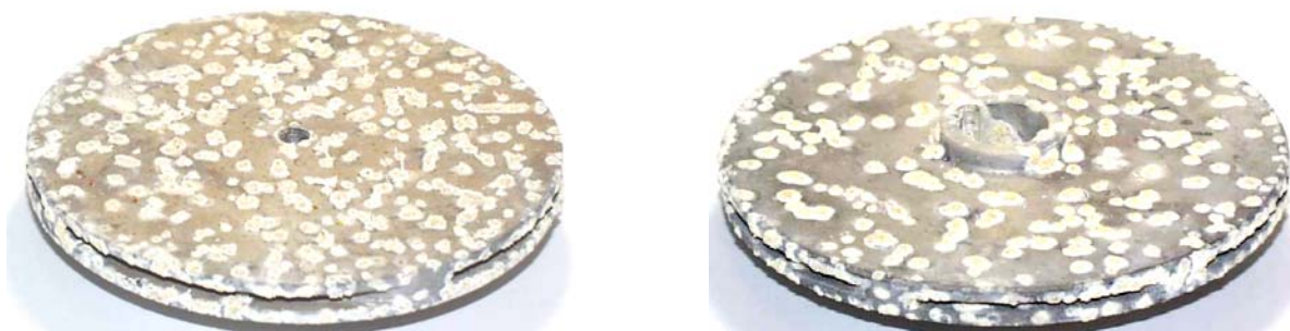
Figura 2 - Rotor em liga de Alumínio 356 fundido em condições normais da indústria (a) e em laboratório (b)
