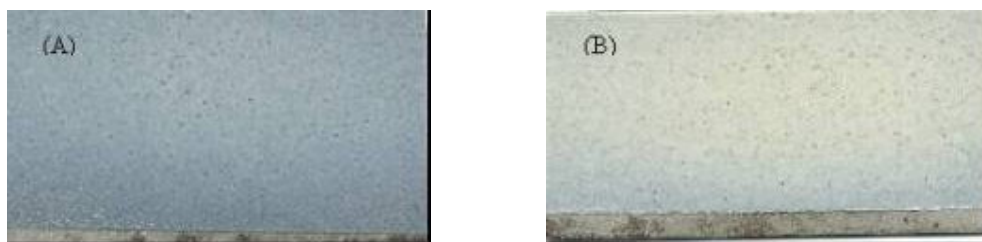
Figura 2 – Recobrimento de PET- o recobrimento (A), mais escuro, possui menor taxa de alimentação e baixa pressão dos gases; espessura de 0,2 mm; o recobrimento (B) indica altas pressões e taxa de alimentação com espessura de 0,4 mm.
