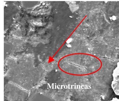
Figura 13 - PTFE com 15%FV e 5%MoS<sub>2</sub> . Pista após desgaste. Aumento 500x. A carga normal é maior: 40N.
