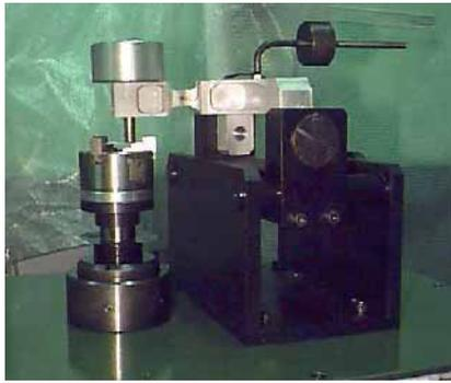
Figura 2 – Equipamento Pino sobre Disco.
