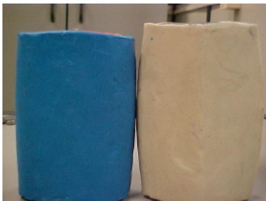
Figura 12. Estiramento para o modelo em plasticina. Prensados entre bigornas planas (esquerda) e bigornas em V (direita)
