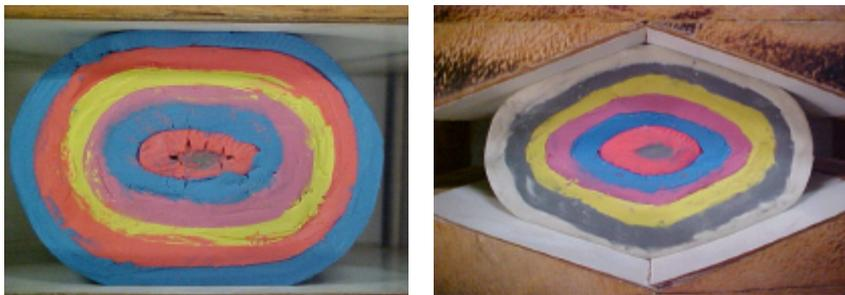
Figura 11. Configuração da face dos cilindros após redução de 20 % na altura
