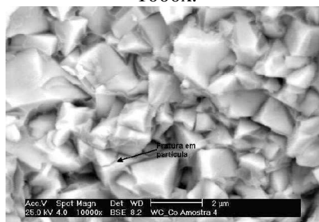
Figura 12. Aspecto dos grãos de WC-Co abaixo da superfície usinada. Amostra 4. Aumento de 1000x.
