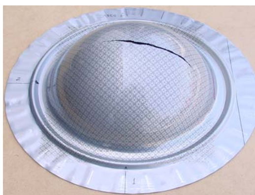
Figura 8. Peça Estampada e Fraturada do Aço Inox 304 no Ensaio de “Bulge Test”.
