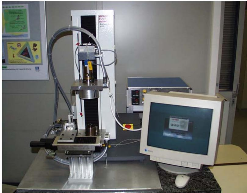
**Figura 4.-** Equipamento de ensaio de compressão e tração.
