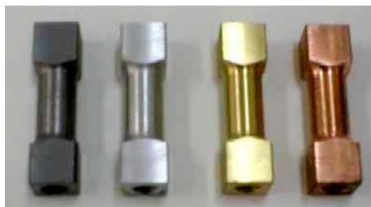
Figura 4. Corpo de prova utilizado nos ensaios experimentais de torção plástica.
