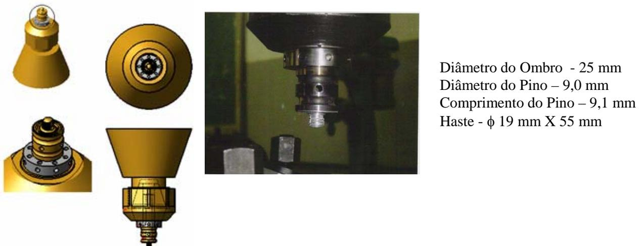
Figura 3. Esquema da Ferramenta FSW
