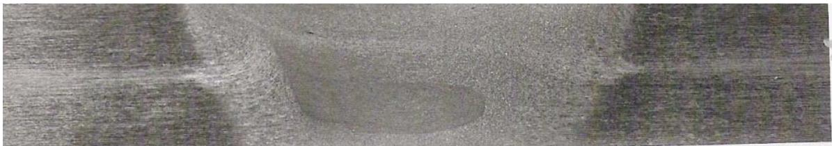
Figura 8. Macrografia da Seção Transversal da Junta Soldada (Centro do Corpo de Prova).
