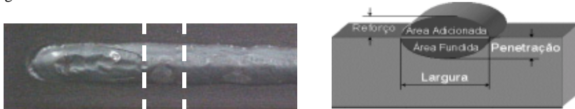
Figura 2 - (a) Posição de corte das amostras no corpo de Prova; (b) Parâmetros geométricos
