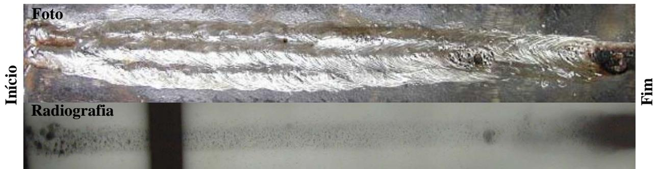
Figura 6 – Radiografia de solda feita a 50 metros em aço A-36 com eletrodo E6013
