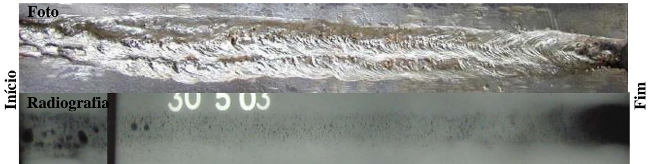
Figura 7 – Radiografia de solda feita a 50 metros em aço A-36 com eletrodo E6013
